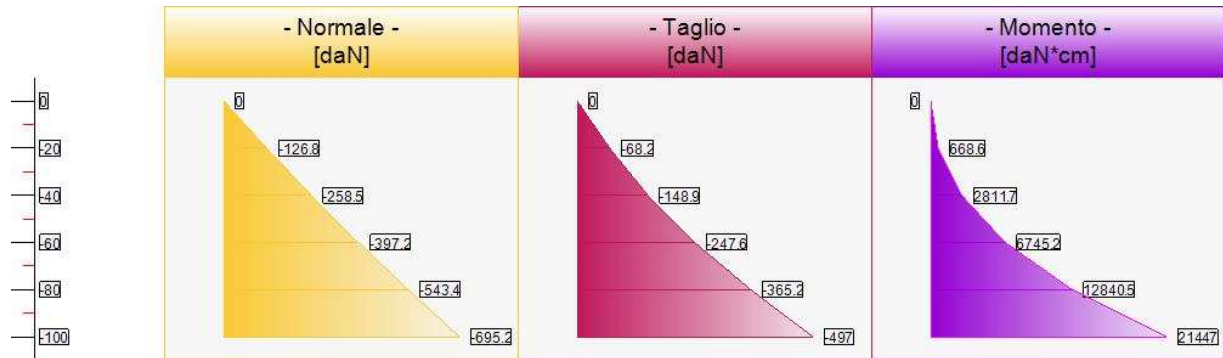
Sollecitazioni lungo il fusto, per il Caso 10 ( RARA [ Caratteristica ] - Combinazione caratteristica (rara) - SLE )
